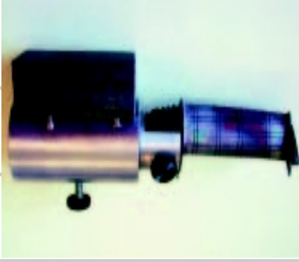
Messung der Restwandstärke und der Beschichtungsdicke.
